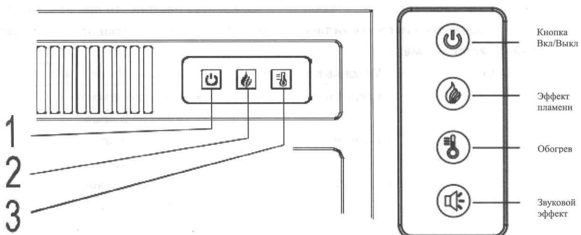
Панель управления электрокамином располагается в правом верхнем углу электрокамина. На панели управления расположены кнопки включения/выключения, контроля яркости пламени, включения/выключения нагревательного элемента. Управлять электрокамином можно с панели управления или с помощью пульта дистанционного управления. В пульт необходимо вставить одну батарейку CR2025 (удалить пластиковый ограничитель).
