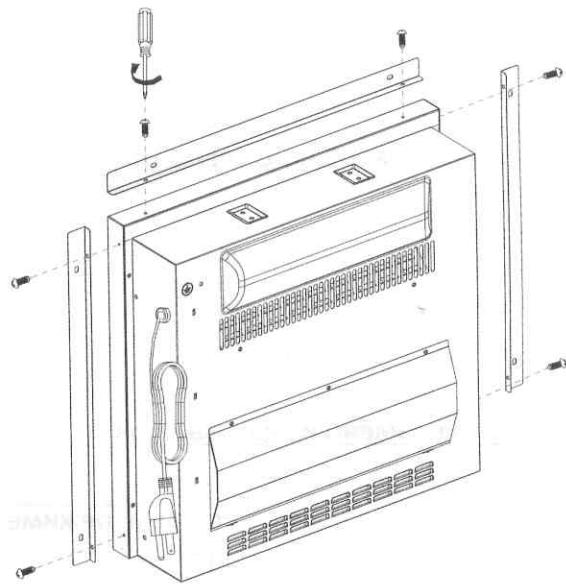
Установка металлических накладок :прикрепите верхнюю рамку к верхней части каминной топки двумя винтами . Совместите и прикрепите две боковые рамки к обеим сторонам каминной топки соответственно с правой стороны и левой стороны, обращенной к передней части устройства, используя два винта.
