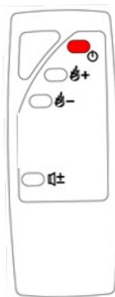
Управлять электрическим очагом можно с панели управления или с помощью пульта дистанционного управления. В пульт вставить батарейки, соблюдая при этом полярность. Пульт поставляется с пластиковым блокиратором в отсеке для предотвращения повреждений и потери энергии. Вытащите блокиратор из отсека.
