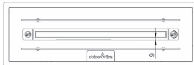
Рис. 7 Воздушный зазор около 9 мм (без крышки)
