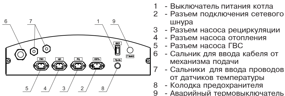
Рис.5 Расположение органов управления на задней панели пульта
