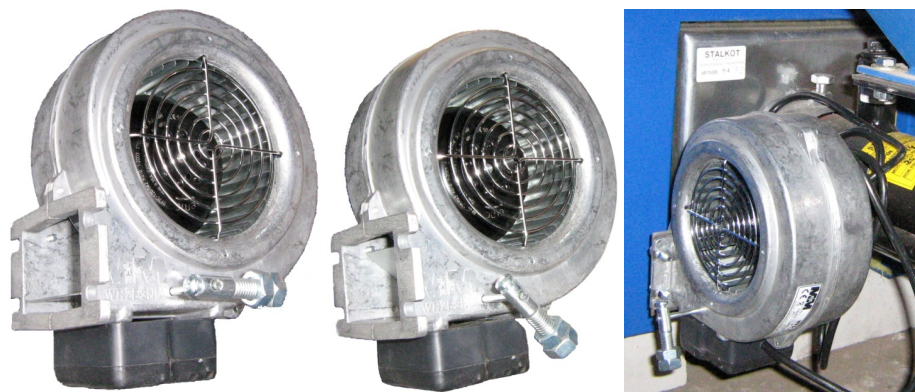
Рисунок 6 – Регулировка положения заслонки вентилятора
