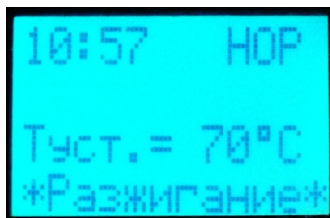
Рисунок 12 – Вид панели управления в режиме РАЗЖИГАНИЕ
