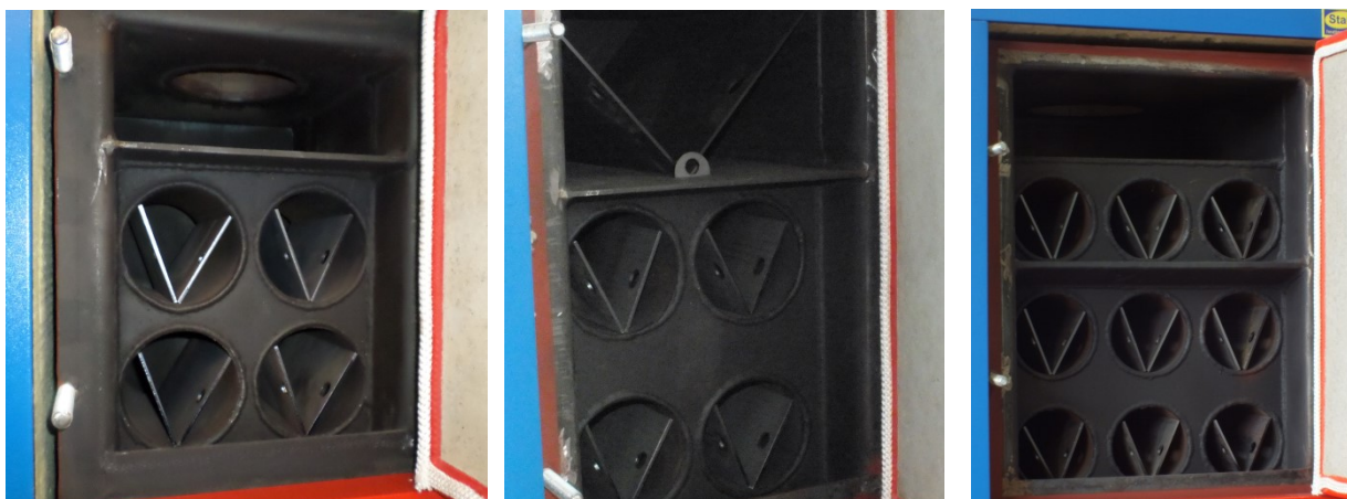
Рисунок 4 – Схема установки турбулизаторов
