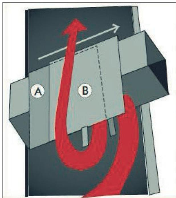
Задвигая дефлектор (B), Вы "увеличиваете поперечное сечение для отвода дымовых газов" и, следовательно, тягу дымохода
