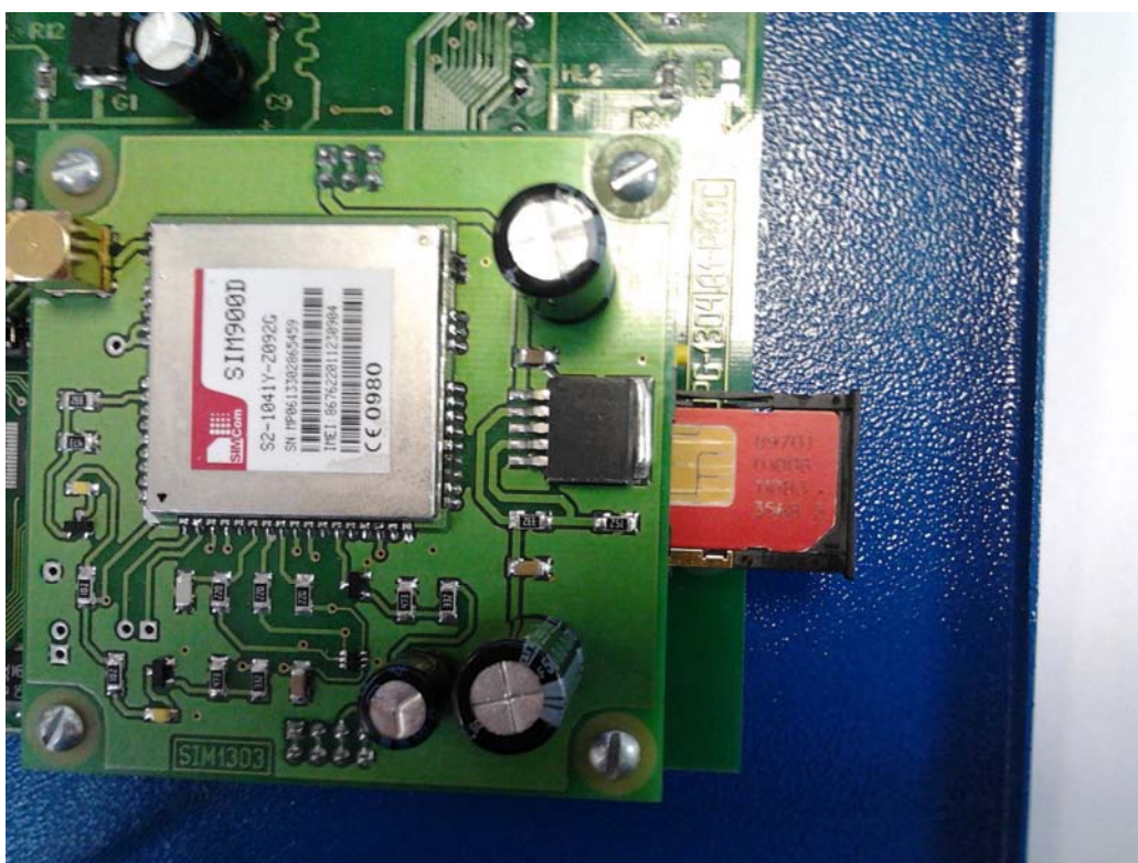
Рис.6.5. Установка лотка на место.
