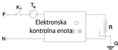
Slika 3. Električna shema digitalnega panelnega grelnika
