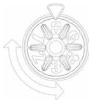
Figura 12. Botão de Ajuste do Termostato
