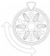
Slika 12. Dugmeta za Podešavanje Termostata
