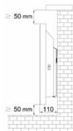
Bild 11. Abmessungen der Standheizkörper in montierter Stellung
