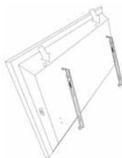
Obr. 8 Uchytenie spodnej časti konvektora
