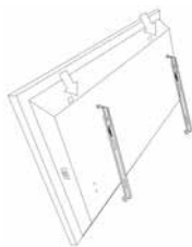
Imagen 10 Visualización posterior de la colocación del gancho superior.
