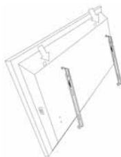
Figure 10. L'accrochage du chet supérieur-vue d'arrière
