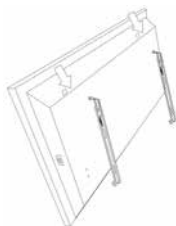
Fig. 10 Vedere spate dispozitiv fixare
