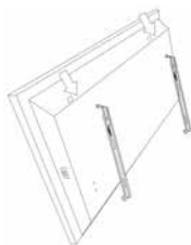
Slika 10. Prikaz montaže gornje kuke na zadnjem panelu
