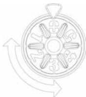
الشكل ٢١ زر ضبط منظّم الحرارة
