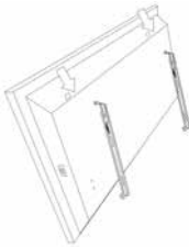
Şekil 10. Üst kancanın takılması arkadan görünüşü
