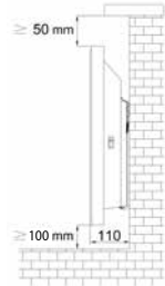
Şekil 11. Konvektörün montaj olmuş ölçüleri
