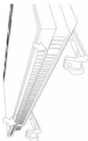
Bild 8. Aufsetzen der Heizung auf unteren Haken
