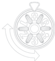
Σχήμα 12: Διακόπτης ρύθμισης θερμοστάτη
