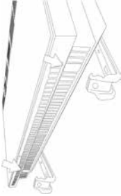
Şekil 8. Alt kancaya konvektörün oturtulması
