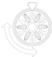
Abb. 12. Regeltaste des Temperaturreglers
