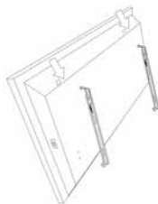
Bild 10. Befestigung des oberen Hakens, Hinteransicht
