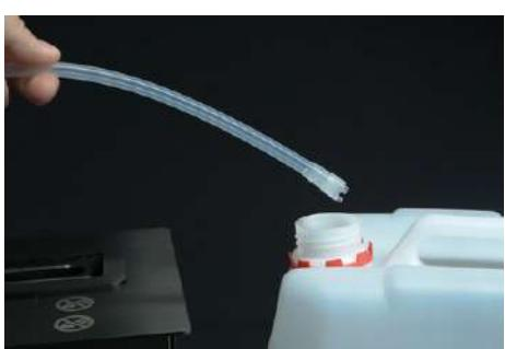
Другой конец заправочного шланга (с фильтрующим элементом) опустите в емкость с биоэтанолом
