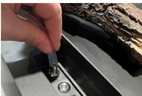
После завершения заправки биоэтанолом отсоедините топливный шланг от разъема заправочной системы
