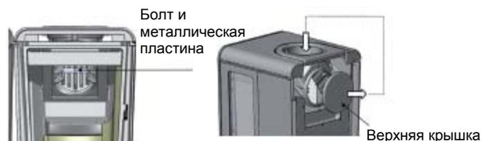
Выломайте кроющую шайбу и установите заднюю пластину на место.
