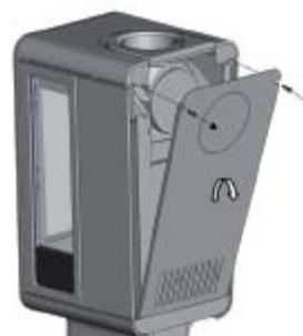
Освободите верхнюю крышку, ослабив болт с внутренней стороны. Она позже будет установлена на верхнем патрубке, если камин не оборудован плитой для готовки (дополнительная принадлежность) – в этом случае верхняя крышка будет находиться сверху.
