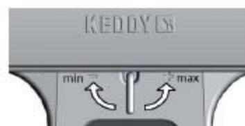
час, зависит от нескольких параметров — длины дымовой трубы и уровня тяги в ней, прогретости камина и дымовой трубы, т.е. длительности работы камина. Главное условие — работа камина должна быть спокойной и гармоничной, при нагретом камине положение регулятора заслонки не превышает 30%, и таким образом достигается уровень выходной мощности 6-7 кВт. (На рисунке сверху регулятор положения заслонки стоит на 50%.)
