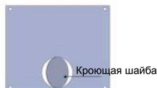
2. Если камин будет соединен сзади, то сейчас необходимо снять заднюю пластину. Ослабьте и снимите два болта в верхнем углу. Наклоните заднюю пластину, чтобы вынуть ее из нижних пазов.
