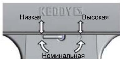
**Внимание! После установки регулятора в положение низкой, номинальной или высокой выходной мощности ось заслонки все равно будет автоматически возвращаться вперед или назад, регулируя подачу внешнего воздуха для последнего выбранного Вами режима мощности. Вы увидите, что Ваше изменение режима мощности привело к изменению степени интенсивности горения спустя несколько минут.**
